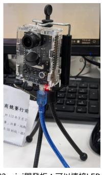
AMB82 mini開發板:可以連接LED、開關、壓力計、濕度計、PM2.5粉塵傳感器等電子元器件。收集到的數據可以通過WiFi上傳,提供應用程式使用,實現物聯網應用。
